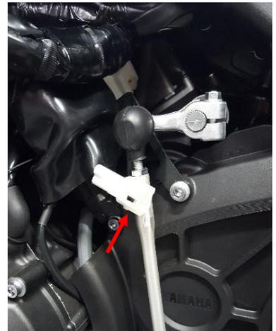
**Fig1. Stock QS Sensor Connector**
